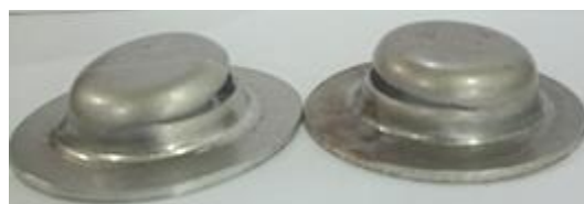
شکل (۱۳): قطعات پاره شده در اثر کم بودن مقدار شعاع.
