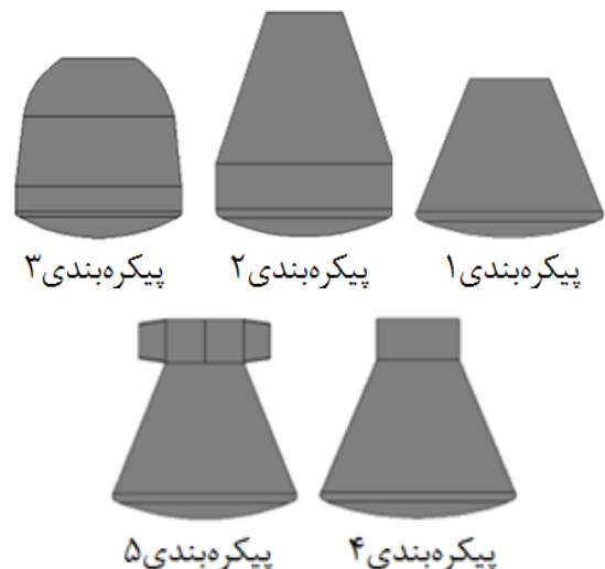
شکل (۲): نمای دوبعدی از شماتیک طرح‌های پیشنهادی کپسول فضایی زیرمداری.
