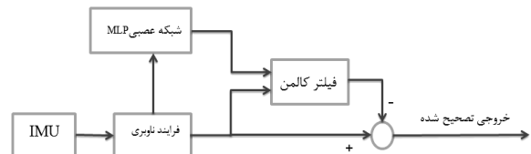
شکل (۵): تصحیح سامانه ناوبری اینرسی در زمان قطع سیگنال GPS با استفاده از شبکه عصبی و فیلتر کالمن.
