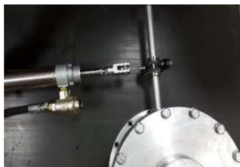
شکل (۹): تبدیل حرکت خطی پیستون به حرکت دورانی
