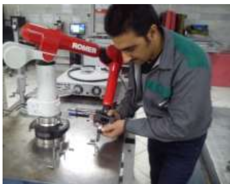
شکل (۷): نحوه اندازه‌گیری قطعات با دستگاه اندازه‌گیر مختصاتی در آزمایشگاه.
