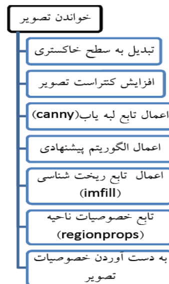
شکل (۲): الگوریتم پردازش تصویر تشخیص شر رنگ [۱۱].
