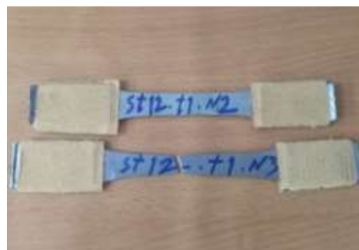
شکل (۳): نمونه‌های قبل و بعد از تست کشش برای تعیین مشخصات مکانیکی فولاد.
