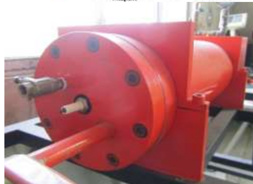
شکل ۱: شماتیک و تصویر سامانه انفجار مخلوط گازها.
