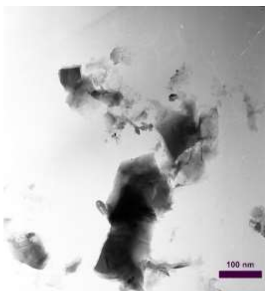
شکل (۴): تصویر TEM رزین حاوی ۲/۵ درصد نانو رس
