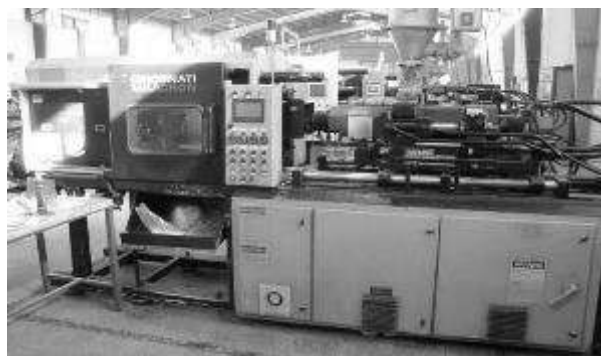
شکل (۱۹): دستگاه تزریق ۱۲۸ ton مدل Cincinnati Milacron
