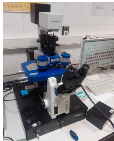
شکل ۴: میکروسکوپ نیروی اتمی جی پی کی مدل نانو ویزارد ۲
