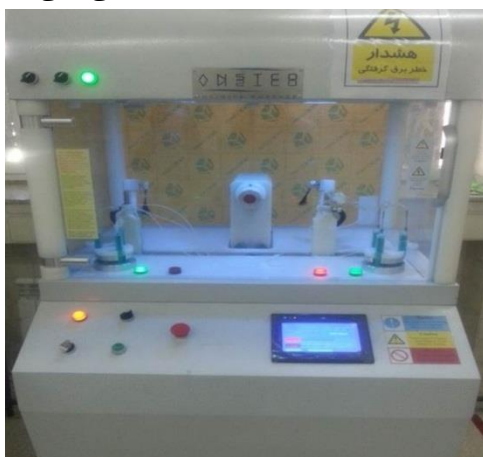
شکل ۱: شماتیک دستگاه الکترورسی افقی
