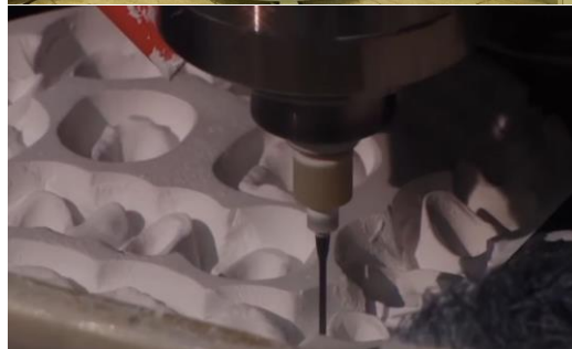
شکل (۳): دستگاه فرز ۵ محوره مورد استفاده
