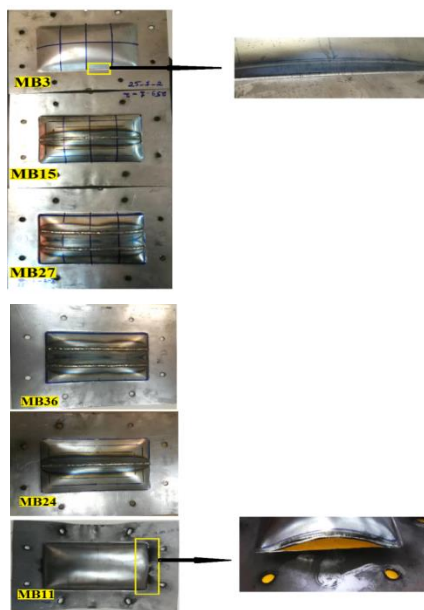
شکل (۴): الگوی تغییر شکل و مکانیسم شکست برای نمونه‌های آزمایشی تحت بار انفجاری ۲۵ و ۵۰ گرم
