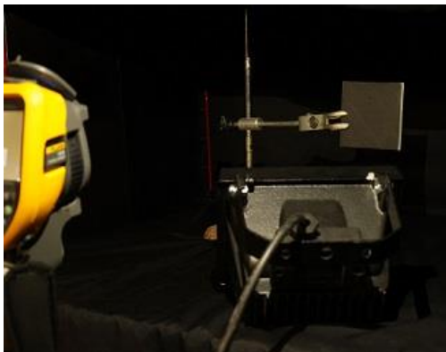
شکل (۳): چیدمان آزمایش در حالت آزمون بازتابی.
