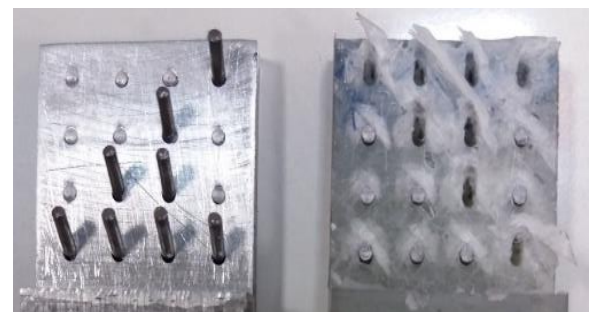
شکل (۲۹): گسیختگی در نمونه B 2 .
