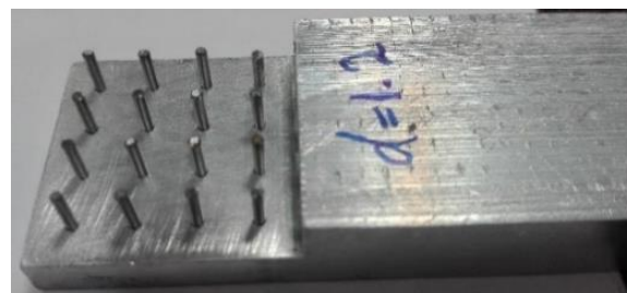
شکل (۹): پرس پین‌ها.
