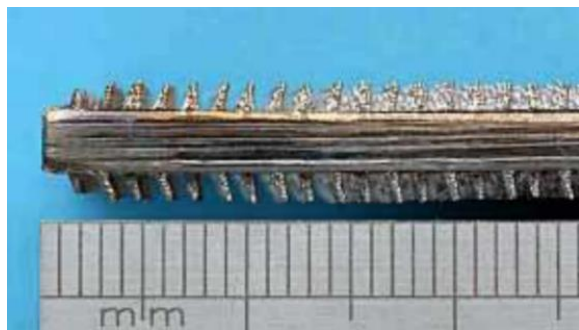
شکل (۱): ایجاد برآمدگی روی سطح فلزی [۸].
