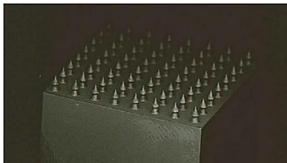
شکل (۵): ایجاد پین با روش ساخت افزایشی [۱۳].
