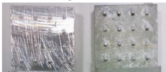
شکل (۲۳): گسیختگی نمونه A_2^+ .
