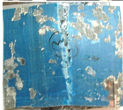
شکل (۸): خطوط گسیختگی در نمونه‌های SP3 و SP4 پس از فروریزش: (الف) نمونه SP3؛ (ب) نمونه SP4؛ (ج) خط گسیختگی رویه پایینی نمونه SP4.
