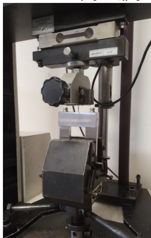
شکل (۶): انجام تست کشش نمونه توسط دستگاه کشش سنتام ۲ تن و فیکسچر طراحی شده.
