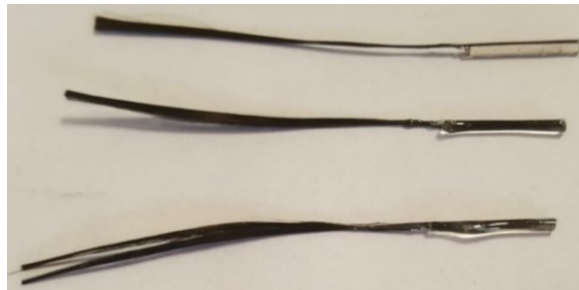
شکل ۴: آماده سازی نمونه ها جهت انجام تست کشش.
