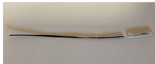
شکل (۷): وضعیت نمونه فیلامنت، پس از انجام تست کشش.
