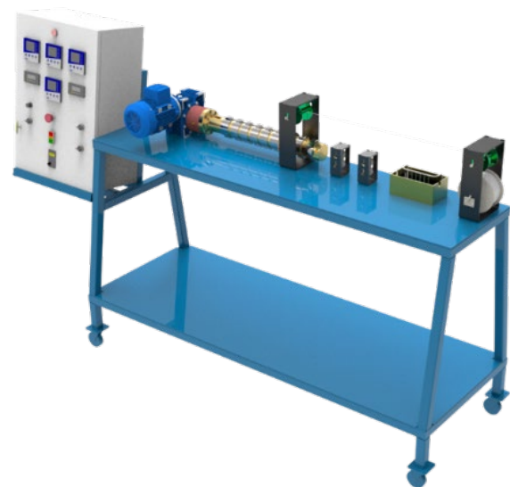
شکل ۳: مدل کامل دستگاه آغشته سازی الیاف کربن.
