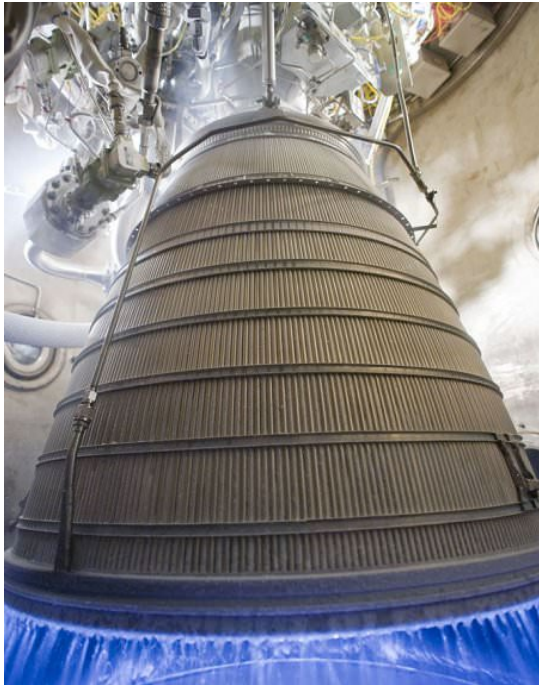
شکل (۲): چیدمان لوله‌های خنک‌کننده بر روی محفظه [۱۹].
