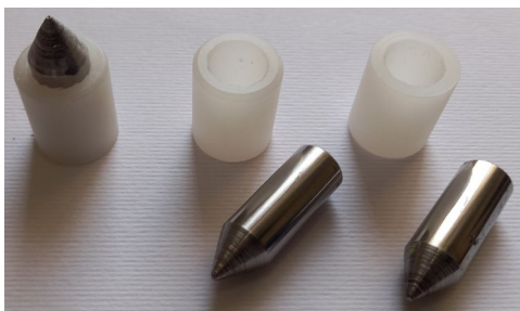
شکل (۱۱): پرتابه به قطر ۱۰ میلی‌متر و سابوت
