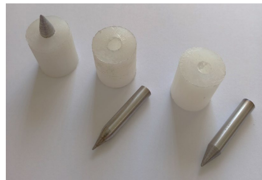
شکل (۶): پرتابه به قطر ۵ میلی‌متر و سابوت مورد استفاده. جدول (۲): مشخصات ابعادی پرتابه HWS به قطر ۵ میلی‌متر.
