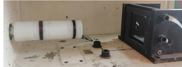
شکل (۴): موقعیت قرارگیری نگه‌دارنده و سنسور محاسبه سرعت ورودی در انتها لوله تفنگ گازی.
