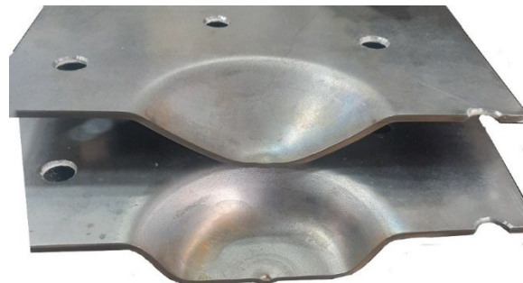
شکل (۹): نمای داخلی نمونه ورق‌های تغییرشکل‌یافته در فرآیند شکل‌دهی انفجاری زیر آب با قالب مادگی با راهگاه.
