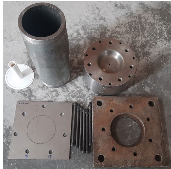
شکل (۴): نمایی از تجهیزات آزمایشگاهی شامل قالب مادگی، نگره‌دارنده، لوله انفجار، نمونه ورق.
