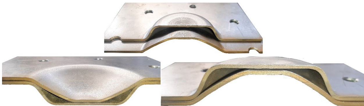
شکل (۱۳): نمای برش خورده و داخلی نمونه ورق‌های تغییرشکل‌یافته در فرآیند شکل‌دهی انفجاری مکرر زیرآب با قالب مادگی بدون راهگاه.
