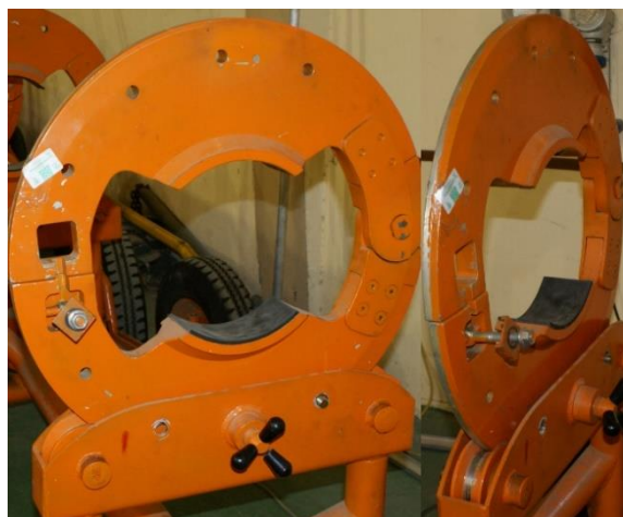
شکل (۲): استندهای چرخان موشک که بر روی پایه قرار می‌گیرند. همراه با این استندها، موشک به راحتی دوران داده می‌شود.
