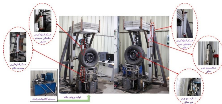
شکل (۳): ساختار آزمایشگاهی مدل سیستم تعلیق یک‌چهارم خودرو
