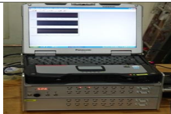
دستگاه داده برداری 32 کاناله KMT مدل MC16/64
