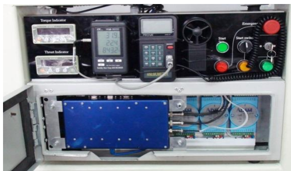
تصویری از جعبه حاوی سیستم کنترل و دیتا برداری
