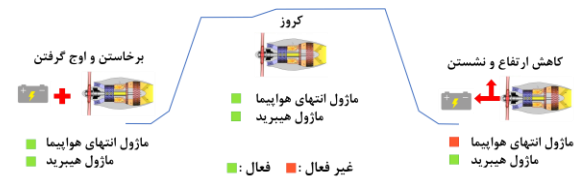
شکل 6: منطق عملکردی کنترلر پیشنهادی برای هواپیما AFT-ATR42 در پرواز
