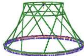
شکل ۱: شمایکی از شرایط مرزی و بار کمانش اعمال شده بر روی سازه مشبک کامپوزیتی در نرم افزار آباکوس
