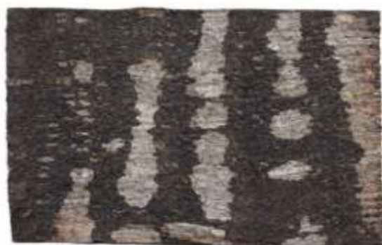
شکل ۶: تصویر سطح نمونه دارای پوشش اینکونل ۶۲۵ بعد از آزمون خوردگی حفره‌دار شدن
