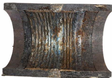
شکل ۱: جوشکاری پوششی اینکونل ۶۲۵ بر روی سطح داخلی لوله API 5L X52
