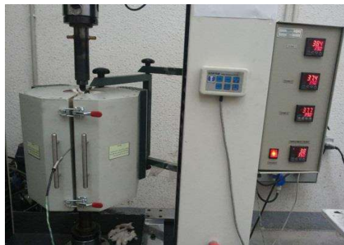
شکل (۶): قرارگیری نمونه در داخل کوره گرمایی جهت انجام تست کشش و خزش
